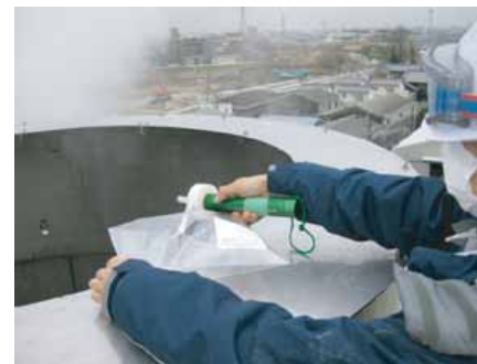
ダクト出口臭気採取
